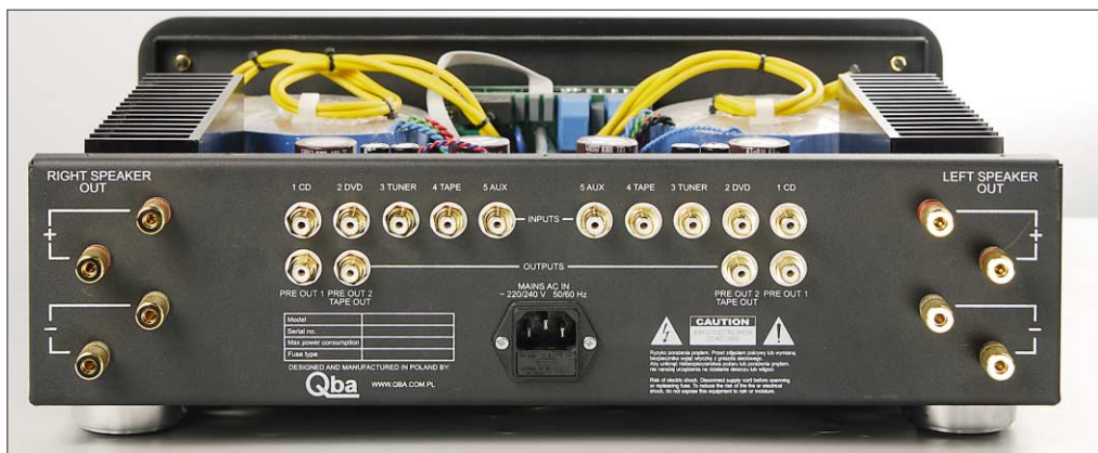
Konstrukcja dual-mono znajduje swe odbicie na tylnym panelu, który również jest symetryczny
