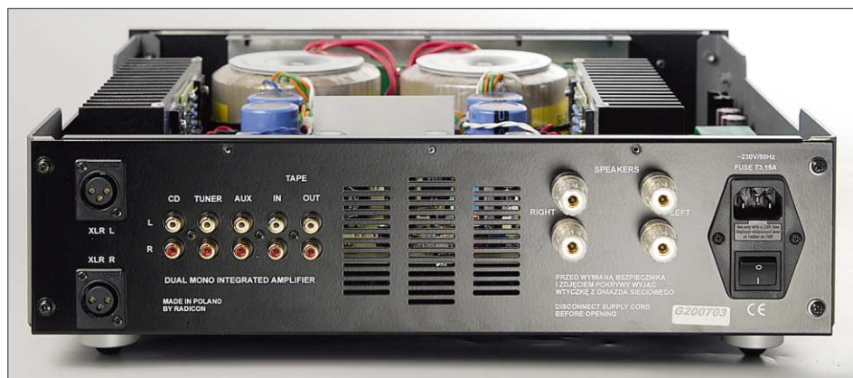
Amplifikator ma gniazda XLR i cztery wejścia liniowe asymetryczne (cinch)
