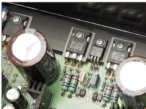
Końcówki mocy zbudowano na dwóch parach Mosfetów IRF na kanał
